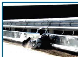
Ensaio TM 1.70 Manequim de 87,5kg, a 70 km/h e 30°, no poste
