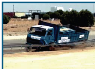
Ensaio TB 42 Caminhão de 10.000kg, a 70 km/h e 15°
